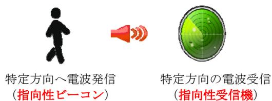
発信側は特定方向に電波を発信し、受信側も特定方向からくる電波のみ受信し、発信側、受信側の電波方位が一致した位置を特定するため、より正確な位置推定が可能
