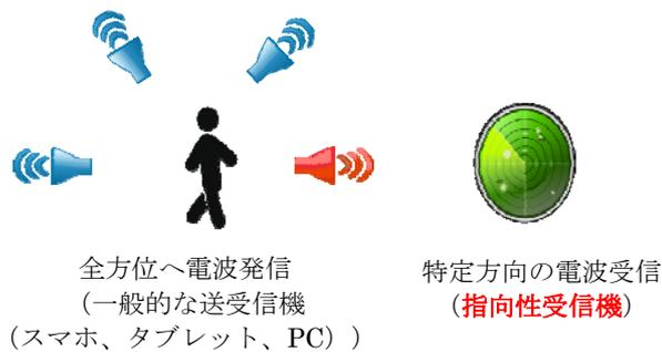
発信側は全方位に電波を発信するが、受信側が特定方向からくる電波のみ受信することで、発信源の位置推定が可能
