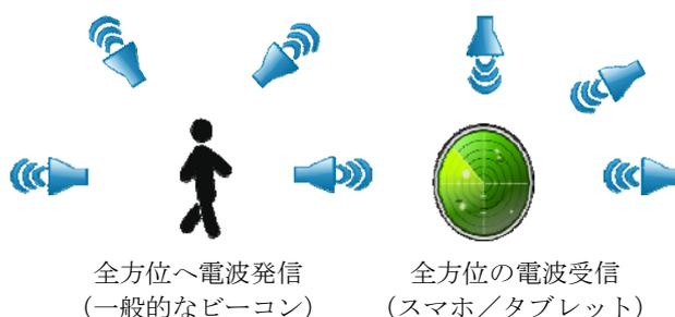
発信側は全方向に電波を発信し、受信側は全方向から電波を受信するように設計されているため、発信源の特定が困難
